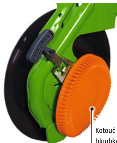
Botka RoTeC (Ø 320 mm) s kotoučem na hloubkové vedení Control 25 Lamely otevřené směrem dozadu zajišťují velmi dobré samočištění.
