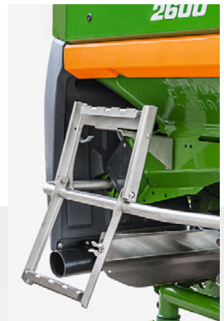
Schůdky z nerezů jsou vhodně zaintegrované do stroje
