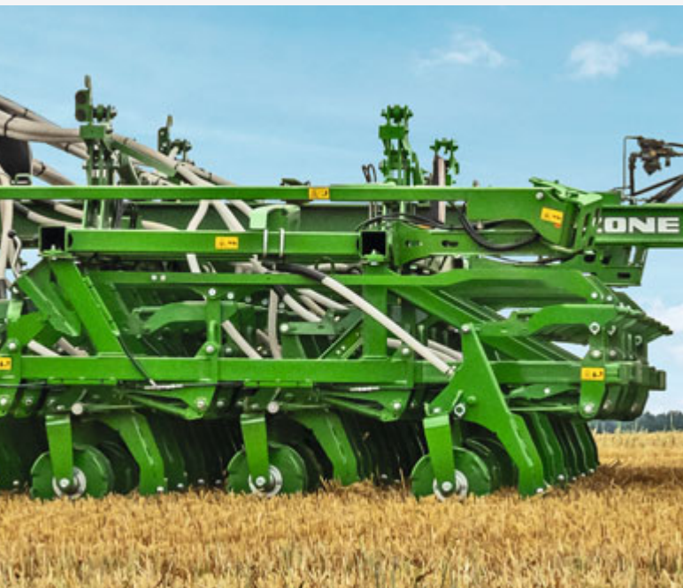
Paralelogramový závěs dlátových radliček
