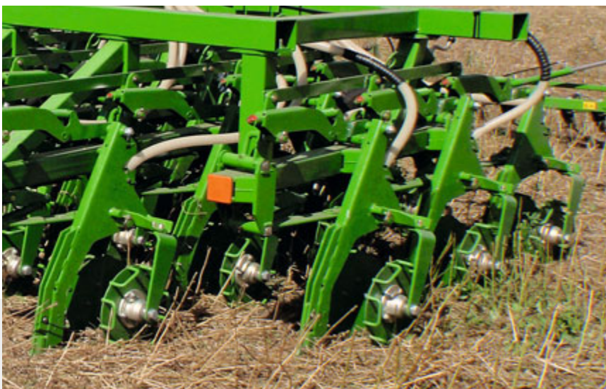
Kolo s výstupky k setí do posklizňových zbytků a na přímé setí
