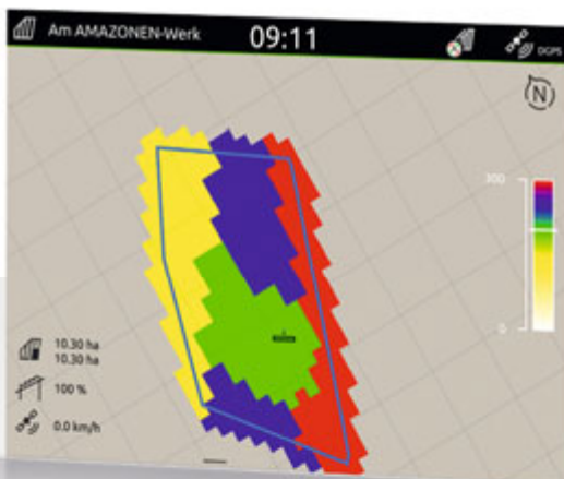
Zobrazení aplikační mapy na terminálu AmaTron 4
