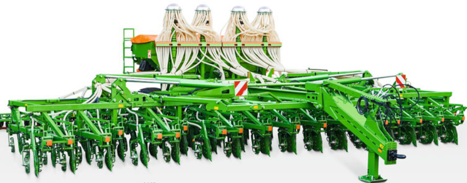
Primera DMC 12000-2C, pracovní šířka 12 m
