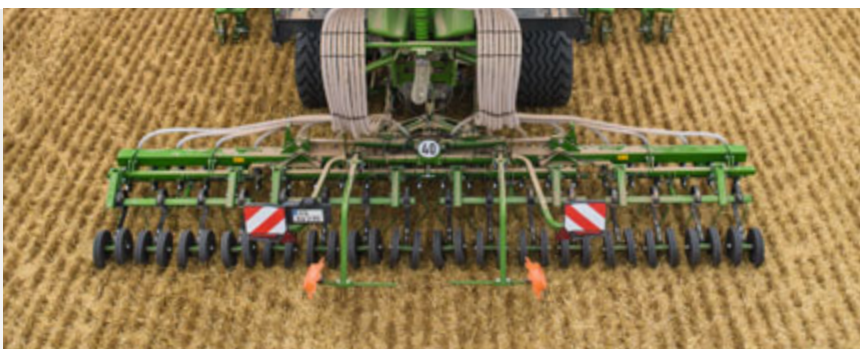
Preemergentní značení Tramline na stroji Primera DMC 6000-2C
