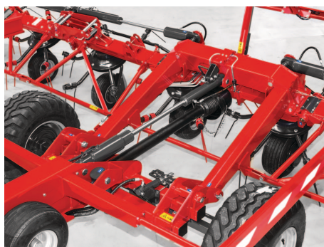
Jedinečný hydraulický systém skládání usnadňuje práci, přepravu a couvání v průběhu rozhozování.
