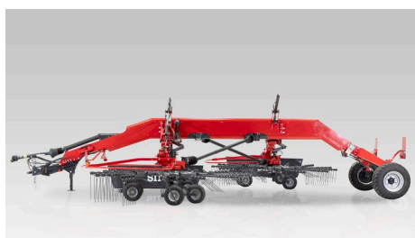
Hydropneumatické odpružení a uložení rotorů 3D+ v kombinaci s otočnou tandemovou nápravou umožňuje dokonalé kopírování terénu bez znečištění píče (H model).
