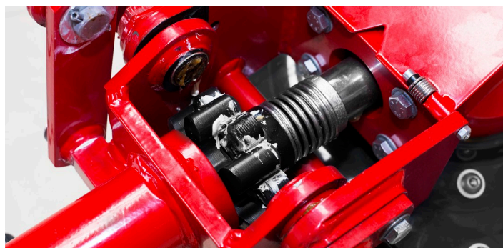
Skládací mechanismus vnějších rotorů v kombinaci se zubovou spojkou umožňuje otáčení o 180° v kompaktní přepravní poloze.
