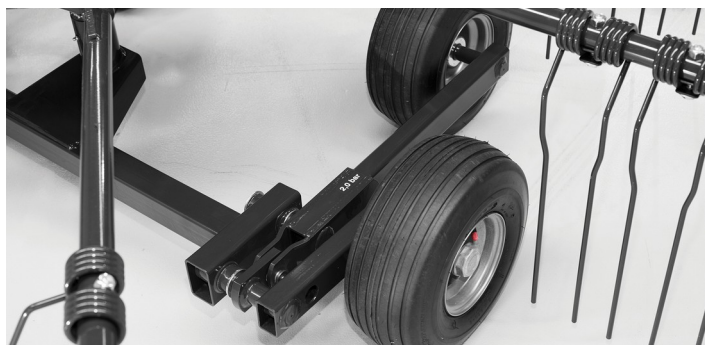
Otočná tandemová náprava (patent SIP) garantuje optimální kopírování terénu, vyšší jezdovou rychlost a přenos zatížení na stroj (STAR 350|8 ALP).
