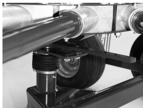
Nastavitelná řídicí dráha \pm 15^\circ v závislosti na množství a vlhkosti píce.
