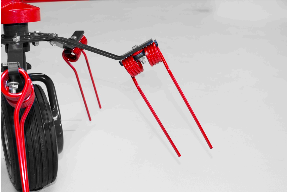
Držáky pružinových prstů z ploché oceli pro optimální rozhoz a obrácení píce. Různé délky pružinových prstů zabrání poškození travního porostu a zajistí čistotu píci.
