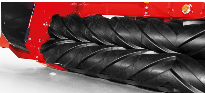
Profilované spirálové válce se otáčejí proti sobě a mačkají stébla podélně, čímž umožňují rychlejší vysychání.
