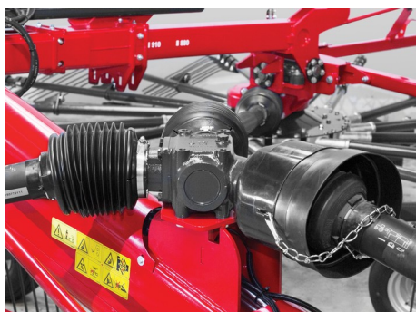
Robustní mechanismus řízení umožňuje úhel otočení \pm 75^\circ , díky němuž může shrnovač perfektně kopírovat stopu traktoru.
