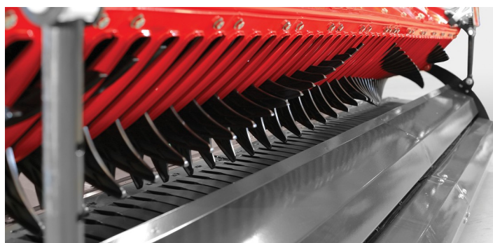
Prstový rotor a sběrné ústrojí zajišťují dokonalé proudění píce.
