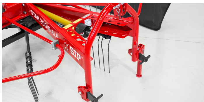
Třibodové pevné spojení (STAR 300|8 ALP).
