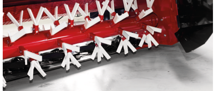
Pevné umělohmotné prsty škrábou a narušují epidermis stonků a lístků rostlin a lámou stonky.
