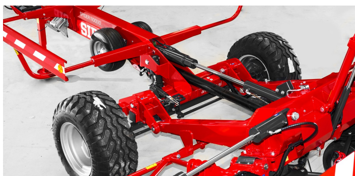
Patentované hydraulické nastavení vzdálenosti pružinových prstů od země podle výšky sečení a množství a vlhkosti píce.
