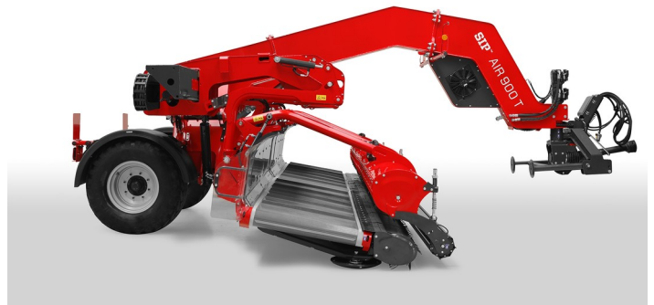
Kombinace flexibilního sběrného ústrojí malého průměru a tažených prstů snižuje znečištění řádků zeminou a kamínky.
