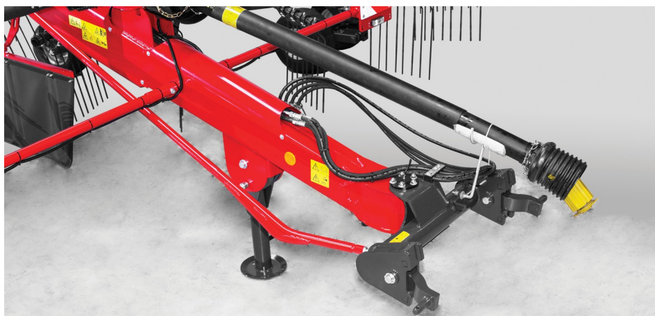
Robustní mechanismus řízení umožňuje úhel otočení \pm 75^\circ , díky němuž může shrnovač perfektně kopírovat stopu traktoru.
