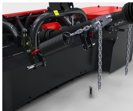
Mechanické odpružení (pružiny)
