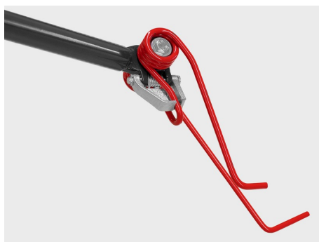
Háčkovitý tvar pružinových prstů (nadstandardní výbava) umožňuje zvedání píče ve dvou vrstvách, což zvyšuje účinnost rozhozování u modelů obracečů s větším průměrem rotoru.
