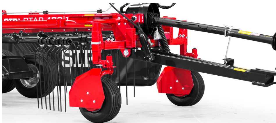
Speciální dvojitě vodící kolo (nadstandardní vybavení) pro lepší kopírování terénu.
