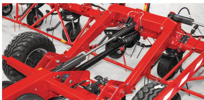
Jedinečný hydraulický systém skládání usnadňuje práci, přepravu a couvání v průběhu rozhazování.
