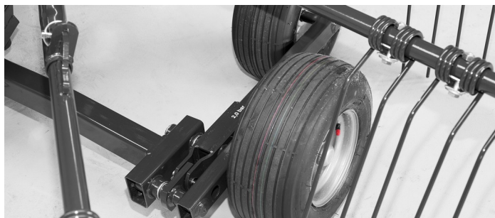
Otočný tandem SIP pro lepší kopírování terénu.
