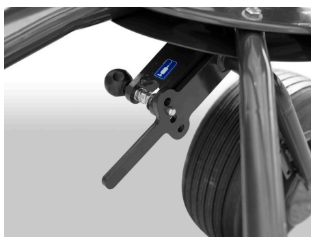
Nastavení úhlu otáčení od 11° do 19° podle množství a vlhkosti píče.
