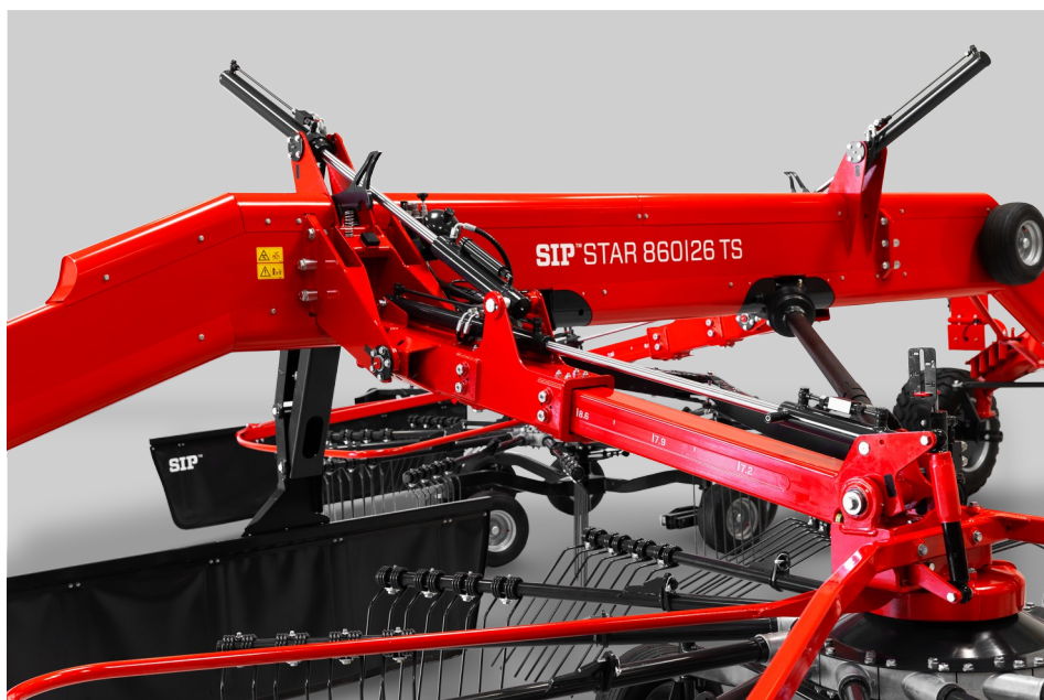
Kombinací teleskopicky nastavitelných rotorů a hydraulicky nastavitelných závěsů pokosu lze vytvořit dva jednoduché nebo jeden dvojitý pokos. Zadní závěs je teleskopický.
