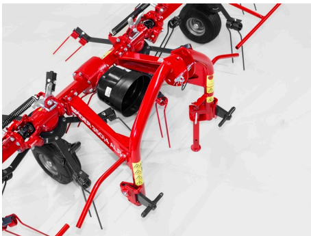
Tříbodové pevné připojení kat. I a II.
