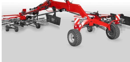
Nová konstrukce podvozku ve tvaru oblouku nabízí více prostoru pro manévrování při přejíždění řádků, protože celý rám shrnovače je vyšší.
