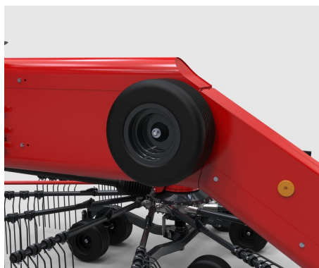
Rezervní kolo 16X6,5-8 s nosičem
