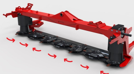
Otáčení diskův ve dvojicích zajišťuje rychlé a efektní odvádění píce přes žací lištu a větší šířku řádku.
