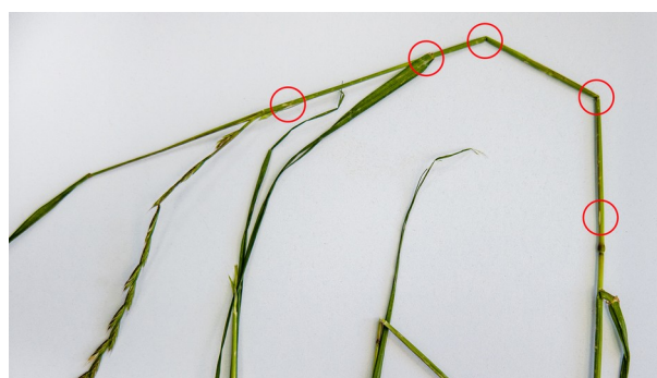
Na obrázku níže jsou znázorněny body, kde prstový kondicionér narušuje epidermis a láme stonky.
