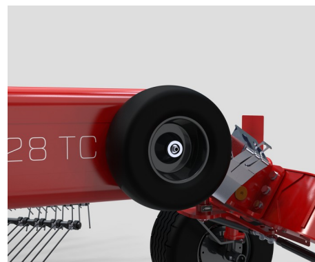
Rezervní kolo 18X8,5-8 s nosičem
