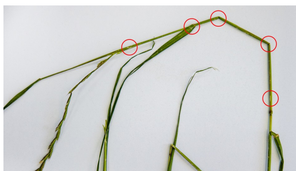
Na obrázku níže jsou znázorněny body, kde prstový kondicionér narušuje epidermis a lámou stonky.
