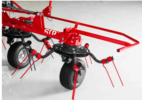
Držáky pružinových prstů jsou vyrobeny z vysoce odolných a robustních trubek kruhového průřezu. Dolní kroužek na rotor nabízí dodatečné zesílení.
