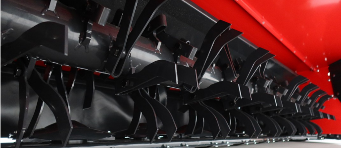
Pružné ocelové prsty narušují, lámou a „nařezávají“ stonky, čímž umožňují rychlejší vysychání.
