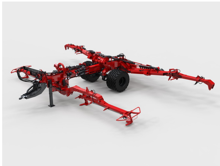
Hydropneumatické odpružení u tažených žacích strojů SILVERCUT DISC 1500 T
