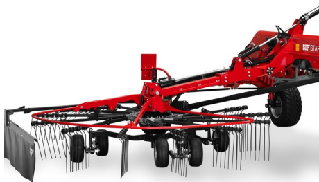
Hydropneumatické odpružení a uložení rotorů 3D+ v kombinaci s otočnou tandemovou nápravou umožňuje dokonalé kopírování terénu bez znečištění píče (H model).
