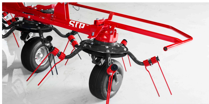
Držáky pružinových prstů jsou vyrobeny z vysoce odolných a robustních trubek kruhového průřezu. Dolní kroužek na rotor nabízí dodatečné zesílení.
