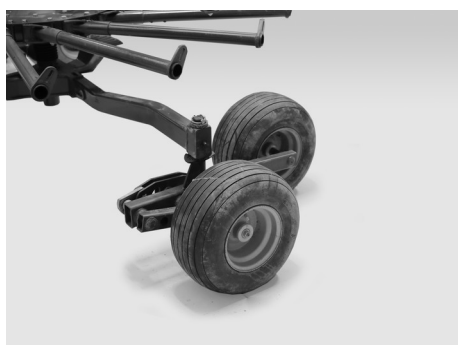
Otočná tandemová náprava (vzadu - nadstandardní vybavení) pro vynikající kopírování terénu. Široký podvozek se 4 nebo 6 koly umístěný v blízkosti pružinových prstů umožňuje vytvářet rovnoměrný a čistý řádek.
