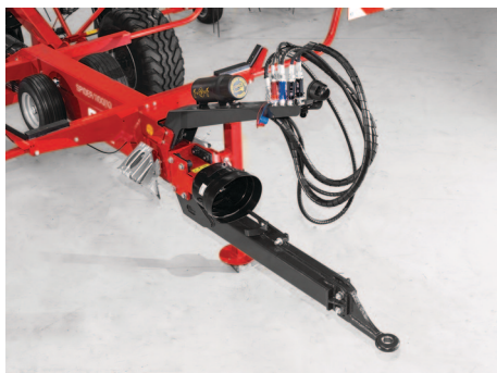
Nastavitelná oje s přepravním rámem pro rychlost až 40 km/h.
