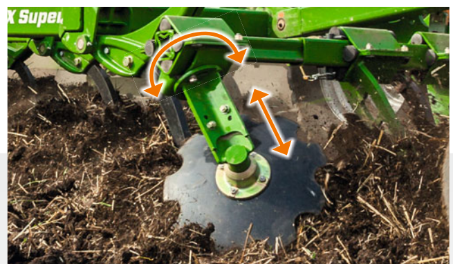
Krajní disk – samostatné nastavení výšky a úhlu
