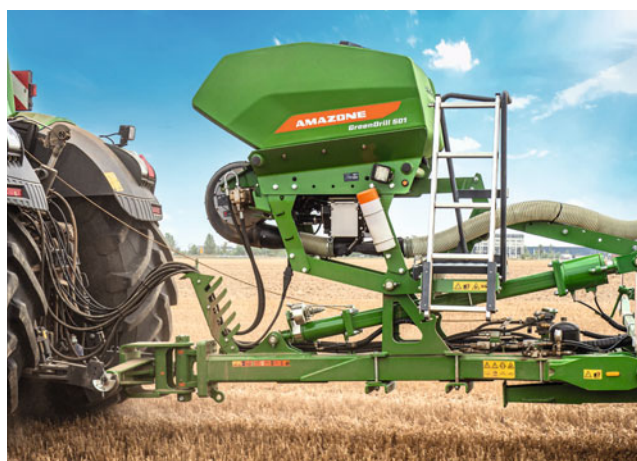
GreenDrill 501: pro všechny tažené stroje se zásobníkem o objemu 500 l a hydraulickým ventilátorem
