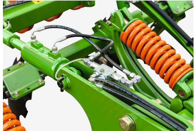
Válec pro hloubkové nastavení radličkové sekce
