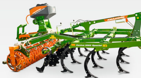
Cenius 3003 Special s nastavbovým secím strojem GreenDrill 200
