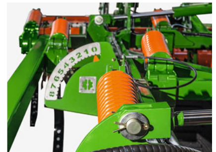
! „Půlkulatá stupnice s laserovým značením sloužící pro zarovnávání je perfektní.“ (praktický test magazínu profi „Tažené kypřiče, část 2“ · 06/2017)
