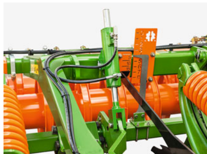
Válec pro hlubkové nastavení zarovnávací sekce
