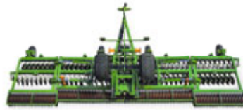
Catros + 12003-2TS s výklopným podvozkem
