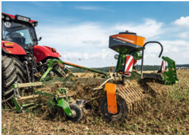
Catros XL 3003 s disky X-Cutter, nožovým válcem a secím strojem GreenDrill
