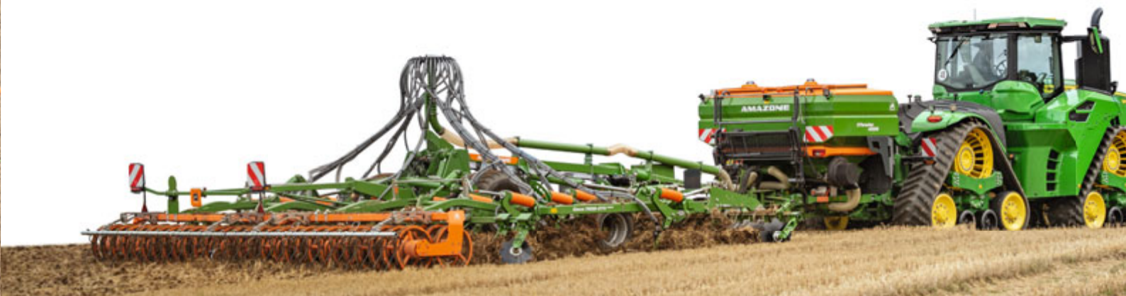
Nesený zásobník XTender 4200 o objemu 4.200 l s kypřičem Ceus 7000-2TX
