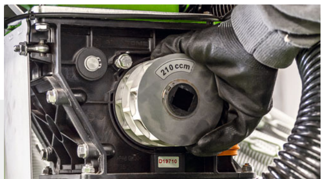
Snadná výměna výsevních válečků
