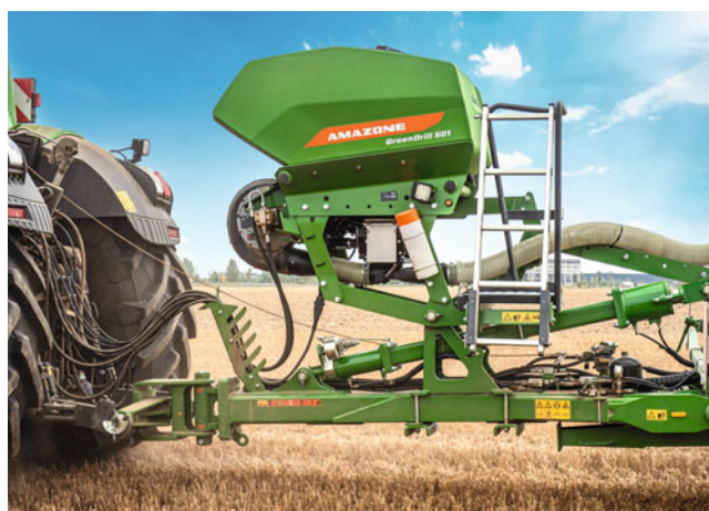
GreenDrill 501: pro všechny tažené stroje se zásobníkem o objemu 500 l a hydraulickým ventilátorem
