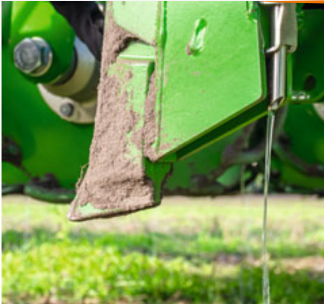
Aplikace kapalného hnojiva přes botku Primera DMC
