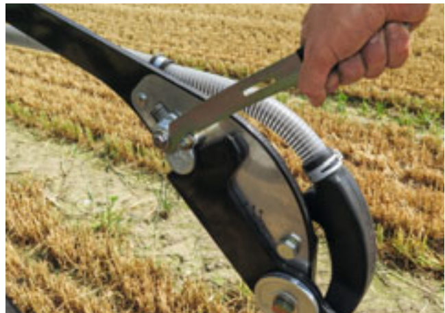
Nastavení dlátové secí botky s vedením pracovní hloubky
