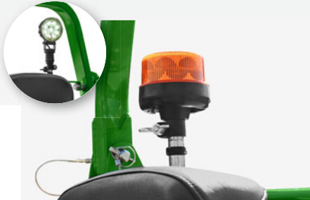
Diodový pracovní reflektor a/nebo majáček
