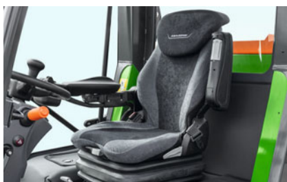
Různé varianty sedadel, např. sedadlo „De Luxe“ Grammer s pneumatickým odpružením a vyhříváním
