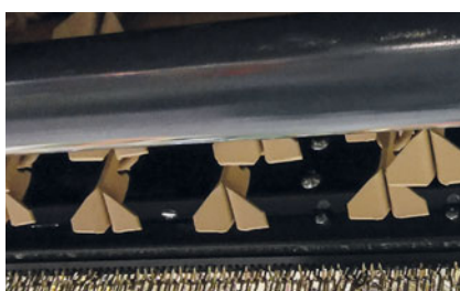
Opěrné válce potažené polyuretanem
